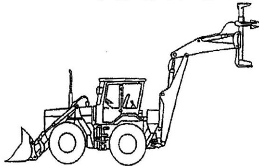
Esempio di terna con attrezzatura per la posa di pali
